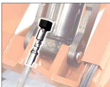
Zamek hydrauliczny zabezpieczający dźwignik w przypadku nagłego obniżenia ciśnienia.
