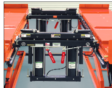
Dźwigniki osiowe o udźwigu 2 722kg.
