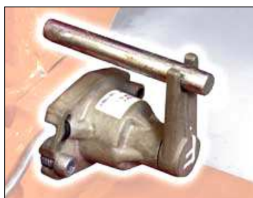
Czujnik położenia (wysokości) platformy
