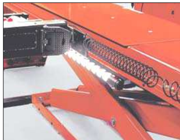
Zasilanie pneumatyczne dźwignika osiowego.
